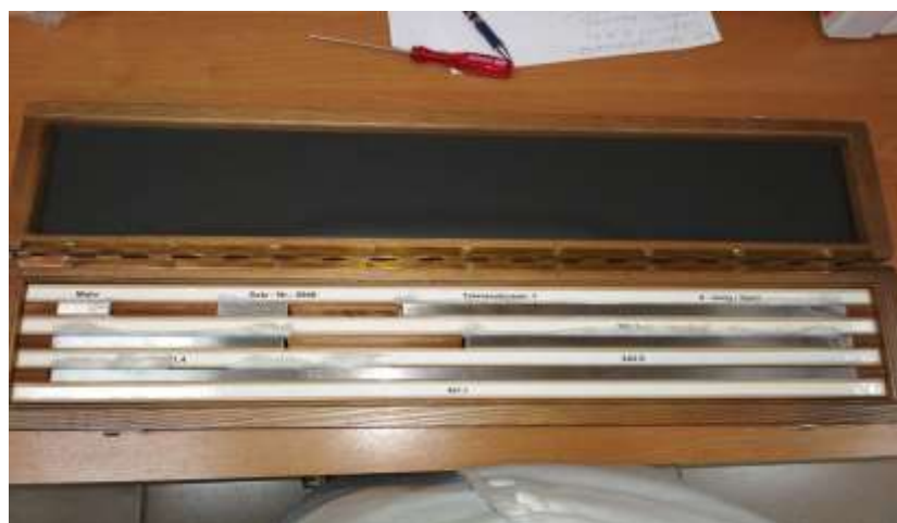
Набор концевых мер длины 1 класса от 30 мм до 481,1 мм в деревянном футляре
