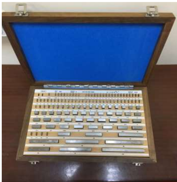
Набор концевых мер длины 0 класса в деревянном футляре
