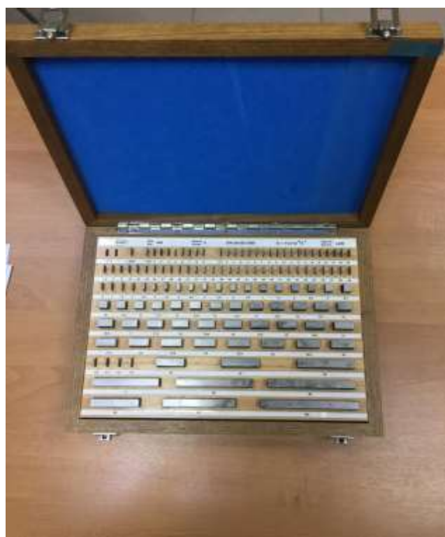
Набор концевых мер длины 0 класса в деревянном футляре
