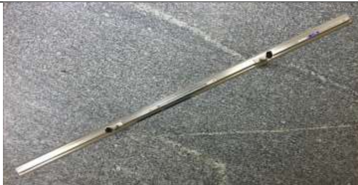
Штриховая мера длины – брусковая линейка 1м
