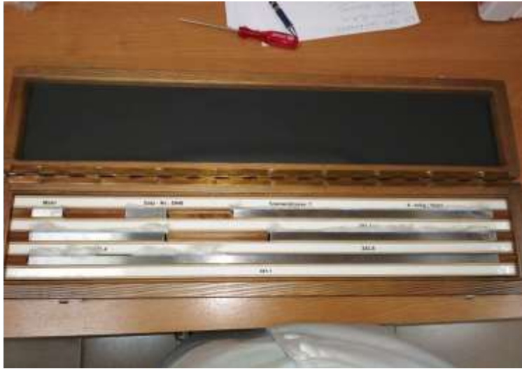
Набор концевых мер длины 2 класса от 30 мм до 481,1 мм в деревянном футляре
