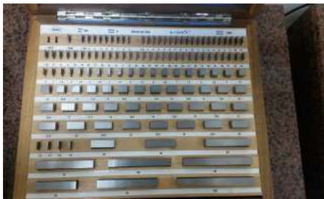
Набор концевых мер длины К класса в деревянном футляре
